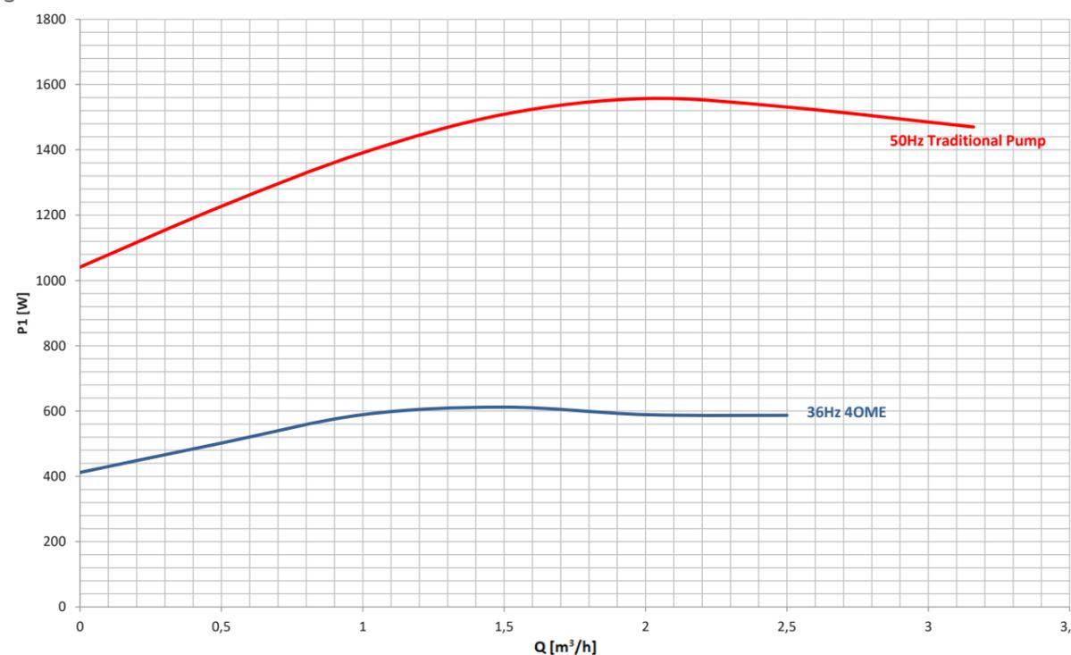
Come si può vedere nel primo grafico (Figura 1), in rosso è rappresentata la curva di una pompa tradizionale a 50 Hz collegata con un motore standard senza inverter. L'area in blu, invece, è l'intera area di utilizzo della stessa pompa collegata al motore sommerso 4OME avente range di funzionamento 15 - 55Hz.
