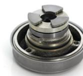
**SISTEMA REGGISPINTA** di tipo Kingbury, con pattini reggispinta in acciaio inox oscillanti su un sistema auto allineante. Un particolare processo di lappatura dei pattini rende questo sistema uno dei più affidabili ed efficienti.
