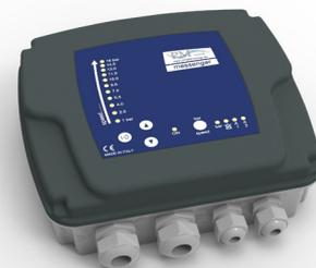
Il dispositivo *MESSENGER* e il motore sommerso 4OME comunicano utilizzando la tecnologia delle onde convogliate, non è dunque necessario aggiungere alcun cavo per permettere la comunicazione tra i due dispositivi in quanto per la comunicazione vengono utilizzati gli stessi cavi dell'alimentazione elettrica al motore.
